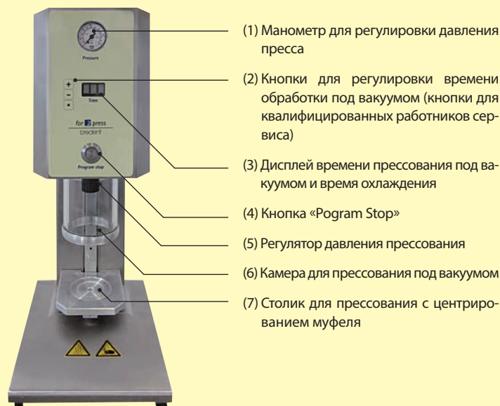
Рис. 1 Фасад устройства для прессования под вакуумом
