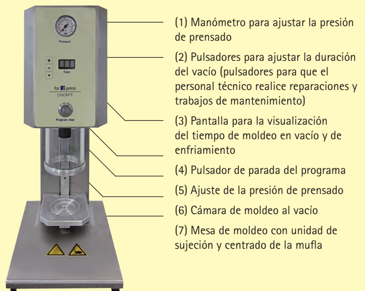
Figura 1: Parte anterior del equipo de moldeo en vacío
